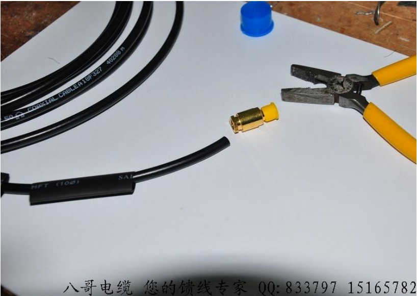
还是套热缩管，切6MM外皮，套上后螺母，内孔大的垫片，硅胶圈，将内孔小的垫片套在电缆护套外边边缘处的屏蔽网上（注意是屏蔽网上，不是套外皮上）外翻屏蔽网，插入衬套
