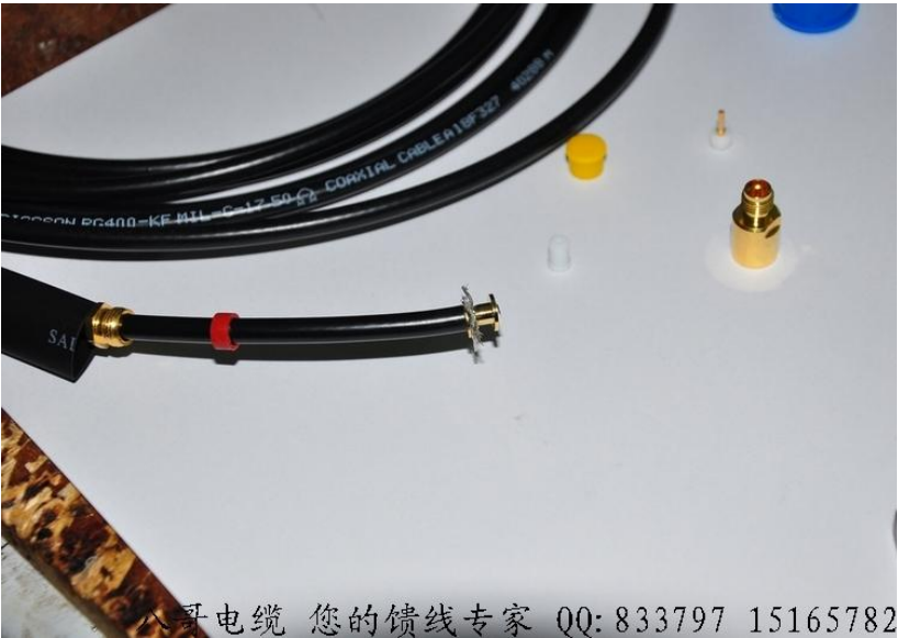
注意看衬套的插入方向，衬套与垫片一起紧密作用挤压住屏蔽网。
